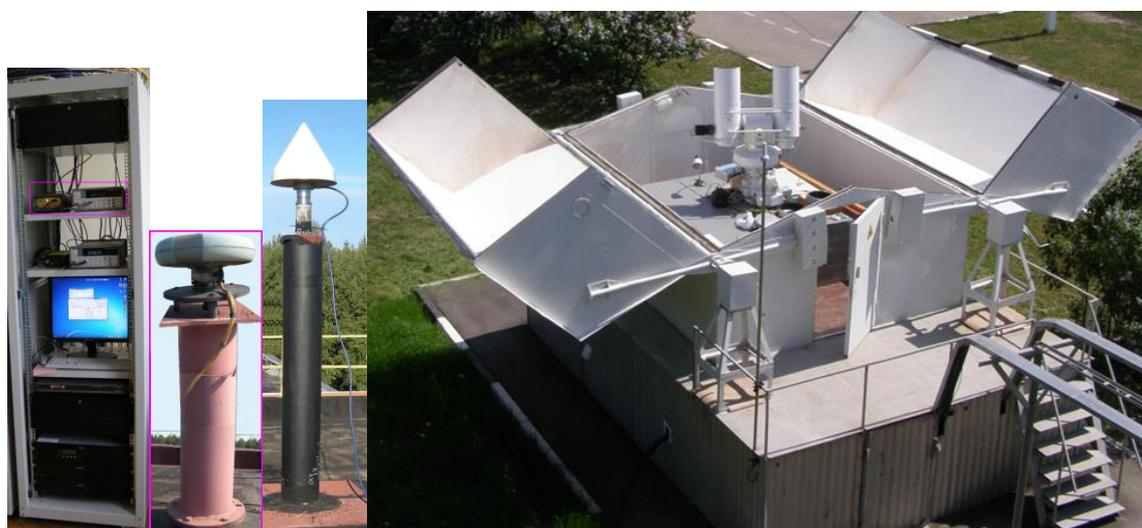
Рис. 2.2. Навигационная измерительная аппаратура пункта определения ПВЗ ГМЦ ГСВЧ (слева) и СЛД «Сажень-ТМ» (справа) [1].
