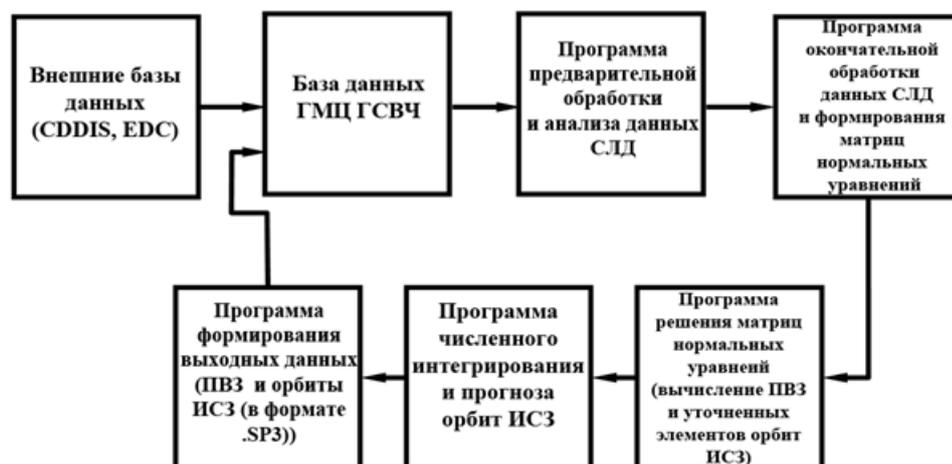
Рис. 4.7. Блок-схема программного комплекса вычисления ПВЗ по данным спутниковой лазерной дальнометрии.
